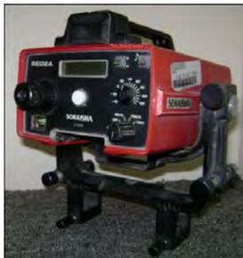
**FIGURA 5.3.** Distanciómetro electrónico. (Fuente: Equipo del Laboratorio de Instrumental Geodésico de la Escuela de Ciencias de la Tierra de la Universidad Autónoma de Sinaloa, México.)
