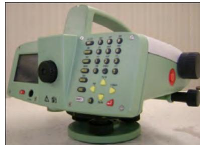
**FIGURA 5.4.** Nivel electrónico de alta precisión N03. (Fuente: Equipo del Laboratorio de Instrumental Geodésico de la Escuela de Ciencias de la Tierra de la Universidad Autónoma de Sinaloa, México.)
