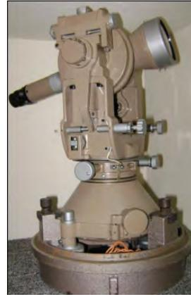
**FIGURA 5.2.** Teodolito de alta precisión T02. (Fuente: Equipo del Laboratorio de Instrumental Geodésico de la Escuela de Ciencias de la Tierra de la Universidad Autónoma de Sinaloa, México.)
