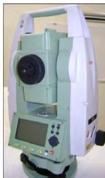
**FIGURA 5.7.** Taquímetro electrónico. (Fuente: Equipo del Laboratorio de Instrumental Geodésico de la Escuela de Ciencias de la Tierra de la Universidad Autónoma de Sinaloa, México.)
